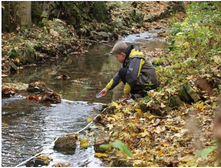
Foto 2: Wie schnell fließt der Fluss? Mit dem Maßband und der Stoppuhr haben das die Schüler*innen ganz einfach ausgerechnet.
